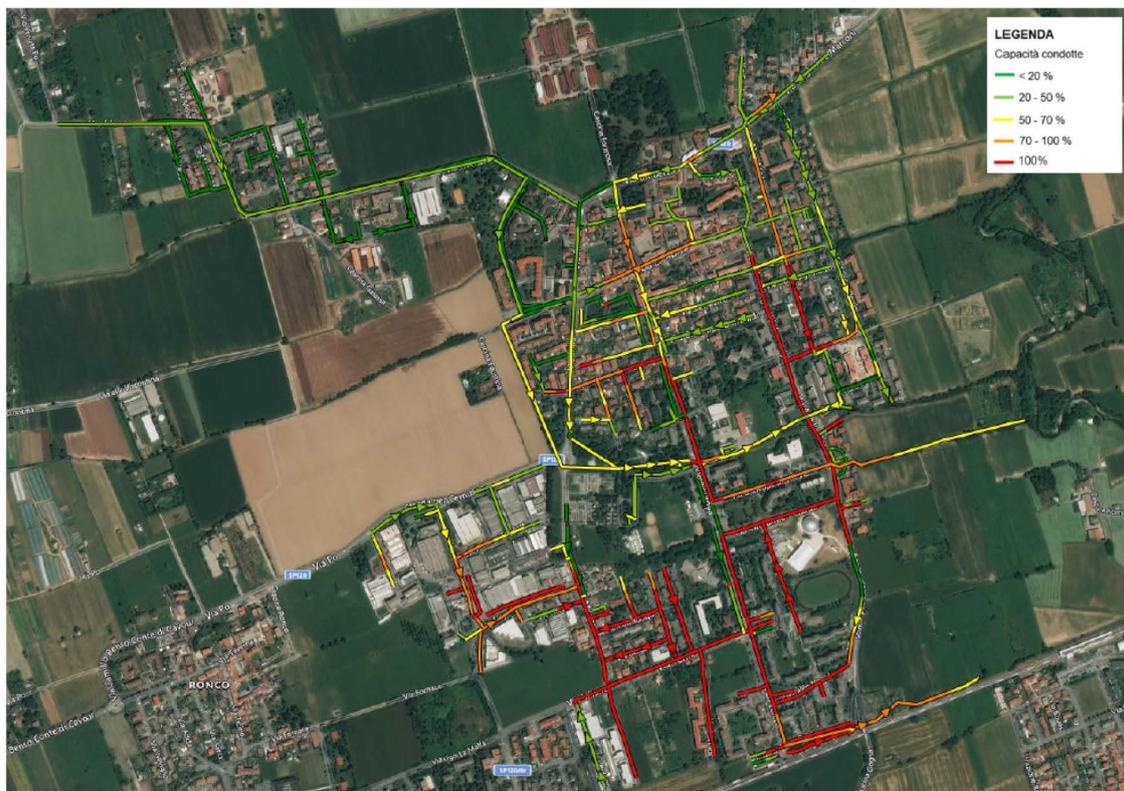
Figura 31 Risultati stato di progetto – sovraccarico delle condotte Tr 2 anni
